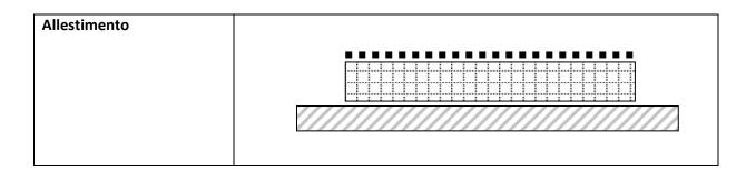
I campioni di prova sono stati inseriti in un telaio perimetrale metallico e i bordi sono stati sigillati con nastro acusticamente riflettente, in modo da minimizzare gli effetti dovuti alla presenza dei bordi.
